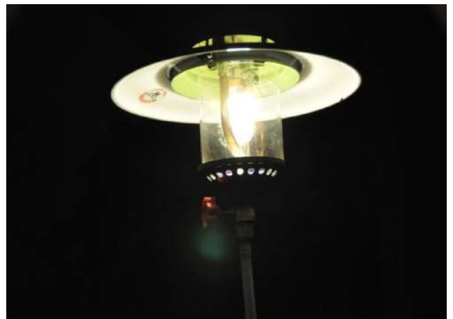
Gambar 13: Biogas untuk lampu
